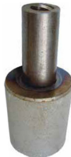
Kvarsittande Betongkona 15 är ett smidigt system för vattentäta väggar. Tillsammans med formstag \varnothing 15 säkerställs rätt väggjocklek samt vattentät lösning.
