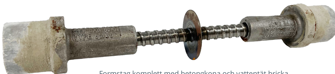
Formstag komplett med betongkona och vattentät bricka
